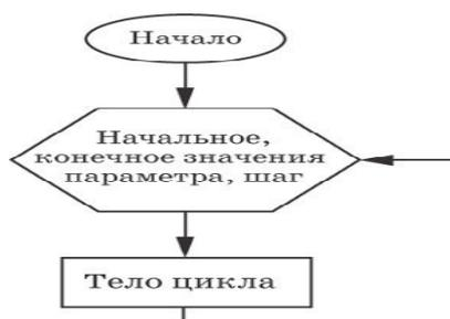
Рис. 2.26. Блок-схема цикла с параметром
