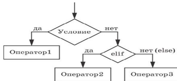
**Рис. 2.17.** Блок-схема условного оператора с двумя условиями
